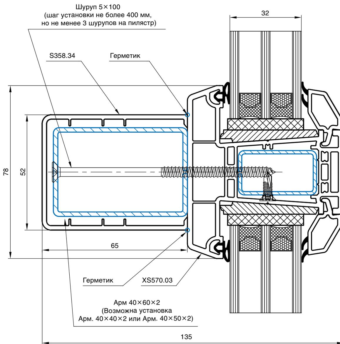
\* — в створках с высотой 1500 мм и (или) шириной 700 мм использовать армирование толщиной 2 мм.
