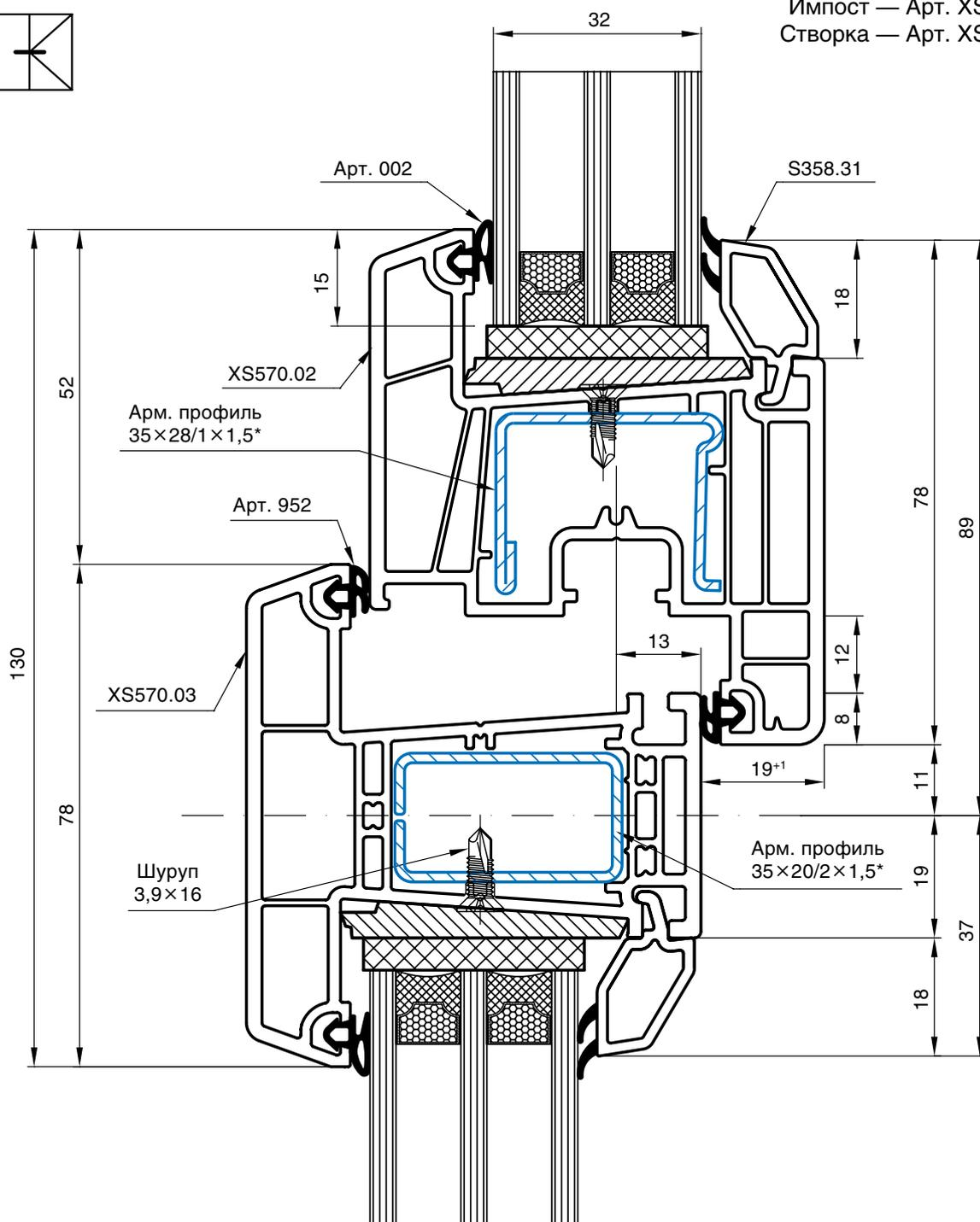
\* — в створках с высотой 1500 мм и (или) шириной 700 мм использовать армирование толщиной 2 мм.
