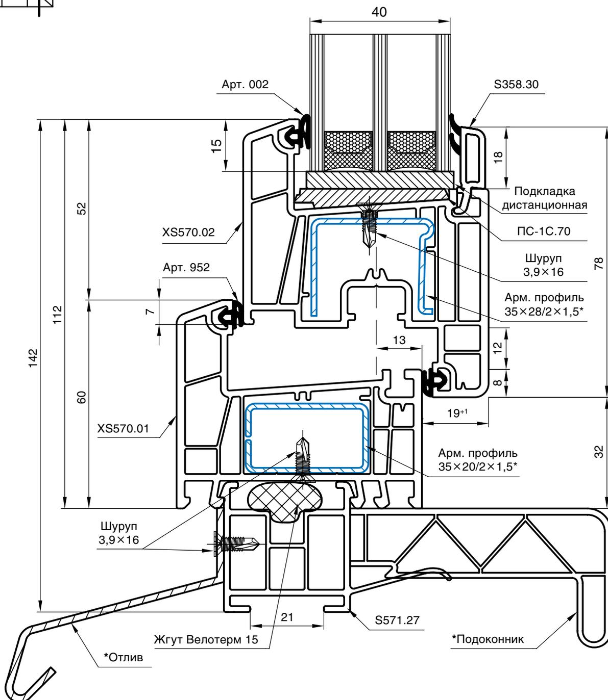
\* — в створках с высотой 1500 мм и (или) шириной 700 мм использовать армирование толщиной 2 мм.
